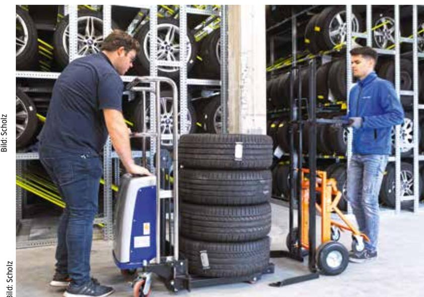
Dazu muss der Reifenstapel einfach über der Gabel platziert und abgesetzt werden.
