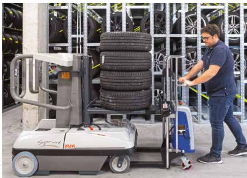
Im Anschluss wird der Stapel mit dem Übergeber auf das Regalbediengerät „Gorilla“ verladen.
