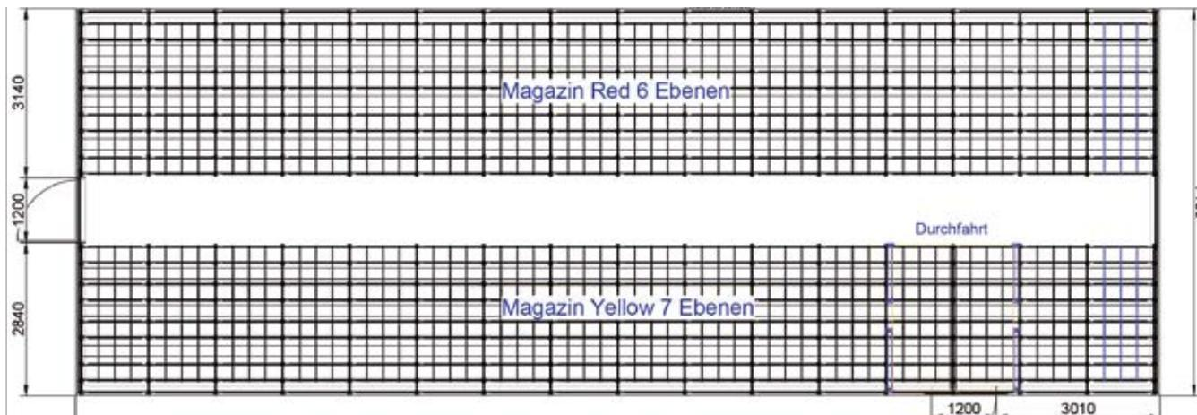
Diese Cover-Halle hat 144 m<sup>2</sup> und bietet auf sechs bzw. sieben Ebenen eine Einlagerungskapazität von 3.200 Rädern.
